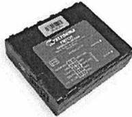
EL DISPOSITIVO **FM1120** ES UNA TERMINAL PEQUEÑA DE RASTREO EN TIEMPO REAL CON GPS/GLONASS Y CONECTIVIDAD GSM, CAPAZ DE RECABAR COORDENADAS Y OTROS DATOS ÚTILES PARA TRANSFERIRLOS A UN SERVIDOR VIA REDES CELULARES GSM.
